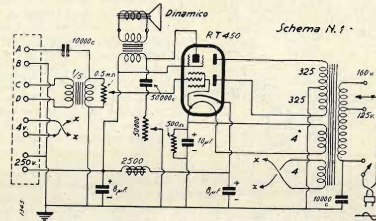
mensioni di 180 x 150 x 70 mm. I due potenziometri per il volume e per il tono, e l'interruttore, saranno fissati su di un lato più corto dello chassis, mentre sul lato più lungo verrà avviato un piccolo schermo in legno dello spessore di un centimetro e forato secondo le dimensioni dell'altoparlante. Al lato opposto allo schermo saranno fissate le boccole di collegamento.
