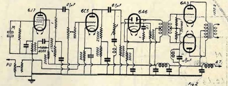
trice triodo 6C5 anch'essa metallica; l'accoppiamento per resistenze-capacità tra quest'ultima e la valvola doppia 6A6 ha un'interposizione di un circuito correttore comprendente una resistenza va-
