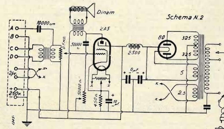
L'altoparlante che abbiamo usato ha un cono del diametro di 140 mm. ed il foro dello schermo da noi utilizzato è di 135 mm. Sulla parte superiore dello chassis si fisseranno i due trasformatori: di alimentazione e di B.F.; dietro a questi le valvole ed eventualmente i condensatori elettrolitici. Sotto troverà posto tutto il resto del materiale.
