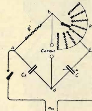
visto otto resistenze da 10 a 1.000.000 di Ohm che permettono di misurare all'incirca tutti i valori di capacità che si può avere bisogno nella costruzione radio-elettrica (tranne quello che concerne i condensatori dei filtri di alimentazione, per i quali è sufficiente applicare la formula indicata in testa al nostro articolo).
