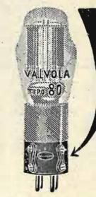
L'INTERRUTTORE AUTOMATICO brevetto Delsedime, dovuto allo studio di un valoroso tecnico dell'F.I.A.R., è di facilissima applicazione. Si inserisce sotto la valvola raddrizzatrice e protegge in tal modo i circuiti interni, indispensabile su tutti gli apparecchi radio, preservandoli da costosissime avarie.
